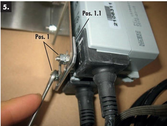
5. Motor wieder in senkrechte Position zur Motorhalteplatte drehen und die Verdreh-sicherung (Pos 1.1) inkl. der beiden Befestigungsschrauben (Pos. 1) von unten in die Langlöcher der Motorhalteplatte einschieben. Darauf achten, dass der Bolzen der Ver-dreh sicherung im Langloch des Motors genügend Freiraum nach oben und unten besitzt, um Unwuchtbewegungen des Motors auszugleichen. Die Muttern der Verdreh sicherung fest anziehen. (Pos. 1).
