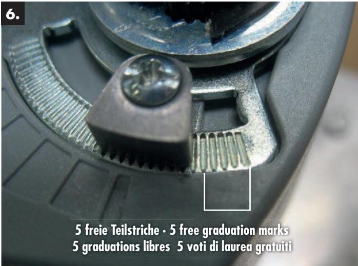
6. Zum Abschluss wird am Motor der obere Endanschlag wie auf dem Foto zu sehen eingestellt, hierzu wird die Schraube mit einem geeigneten Kreuzschlitzschraubendreher (PH1) geöffnet, der Anschlagbock um 5 freie Teilstriche verschoben und wieder festgezogen.
