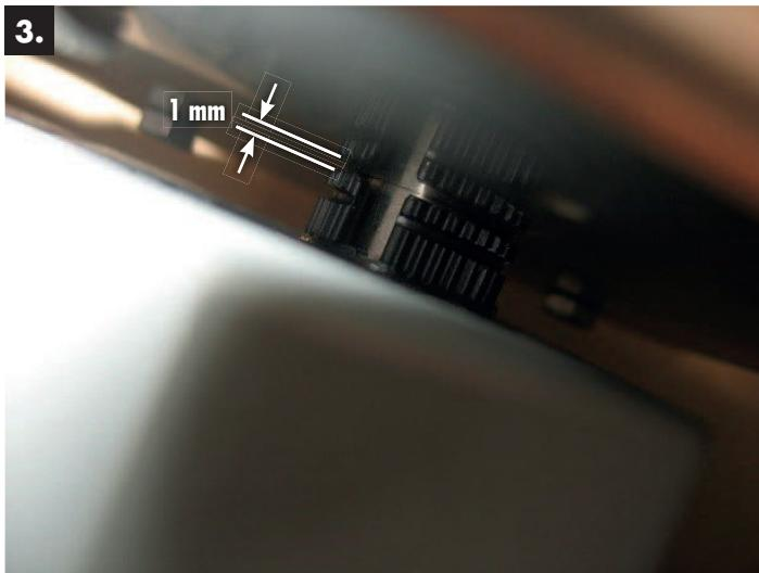
3. Tauschmotor bei geschlossener Klappenstellung auf die Welle aufschieben.
