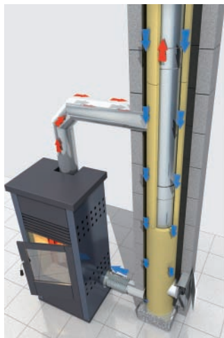
Der LAS-FB mit Innenrohr und Dämmschale in einem Schacht aus zugelassenen Formsteinen z.B. mit Anschluss an einen Pelletofen
