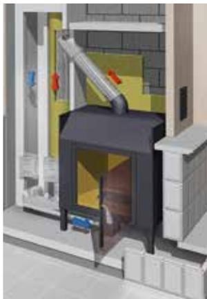
EW-Alkon für Abgas und Verbrennungsluft
