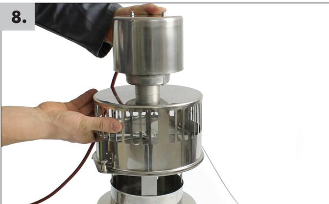
8. Jetzt wird die gesamte Baugruppe in den Schornstein eingesteckt, hierzu werden die vorgespannten Haltwinkel leicht zusammengedrückt und in den Schornstein eingesteckt. Nach dem Einstecken wird der feste Sitz des Rauchsaugers auf dem Schornstein geprüft.
