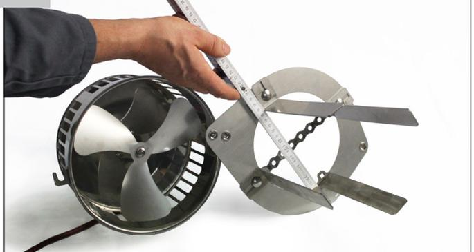
5. Um einen guten Halt im Schornstein zu gewährleisten, wird der äußere Abstand der Haltewinkel zueinander mittels der Langlöcher auf den Einsteckdurchmesser eingestellt und die Muttern festgezogen. Um eine ordnungsgemäße Funktion zu gewährleisten, müssen die Winkel im gleichen Abstand zur Mitte ausgerichtet werden. Anschließend wird der Rauchsauger verschlossen (anheben und drehen).
