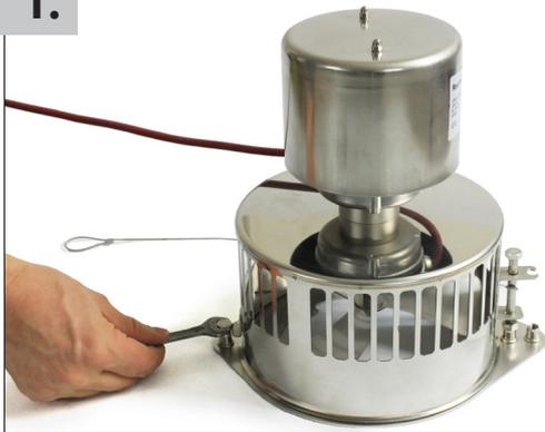
1. Rauchsauger aus der Verpackung nehmen und die vordere Verschlusschraube mittels des 13-mm-Schlüssels lösen, anschließend kann der Rauchsauger durch Verdrehen und Anheben geöffnet werden.
