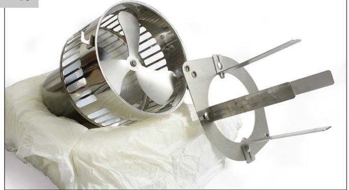
4. Jetzt werden die Einsteckwinkel mittels beiliegenden Schlossschrauben locker auf den Rauchsauger aufgeschraubt, dabei zwingend die Schrauben von unten durch die Winkel und die Bodenplatte stecken, um ein enges Aufliegen am Schornstein zu ermöglichen.
