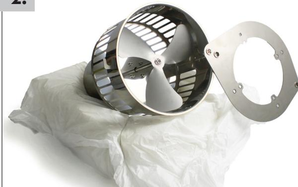
2. Der geöffnete Rauchsauger wird nun zur einfacheren Handhabung in das obere Verpackungsformstück eingelegt.
