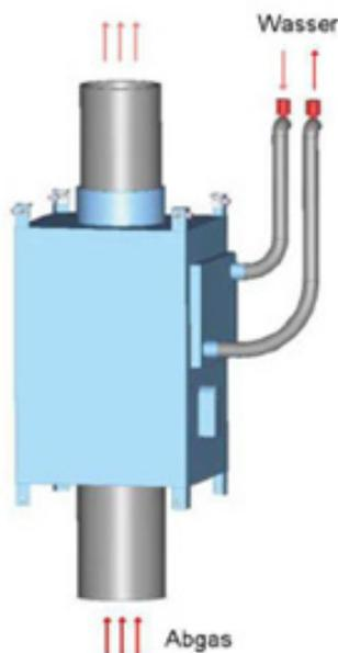
Abb. 5: senkrechte Montage, Abgaseintritt von unten
