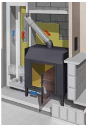
EW-Alkon für Abgas und Verbrennungsluft in einem Niedrigenergiehaus
