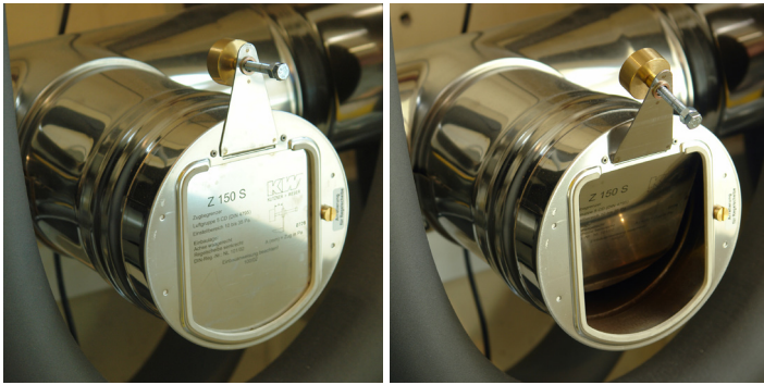
Zugbegrenzer bei geringem Unterdruck: Klappe geschlossen Zugbegrenzer bei zu hohem Unterdruck: Klappe geöffnet, Nebelluft strömt ein
