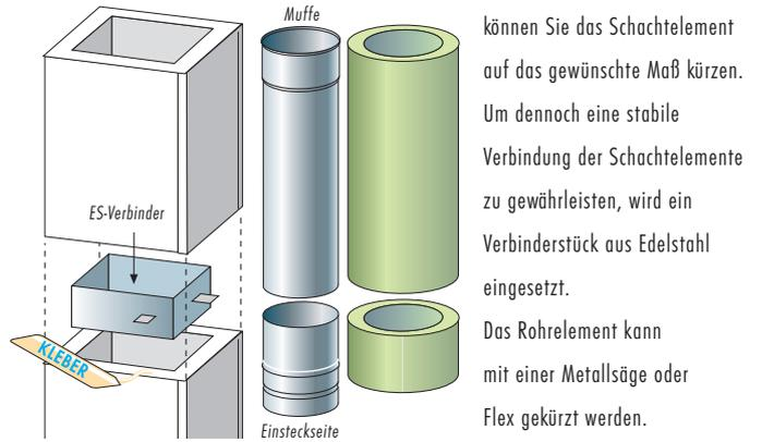
Sie können das Schachtelement auf das gewünschte Maß kürzen. Um dennoch eine stabile Verbindung der Schachtelemente zu gewährleisten, wird ein Verbinderstück aus Edelstahl eingesetzt. Das Rohrelement kann mit einer Metallsäge oder Flex gekürzt werden.
