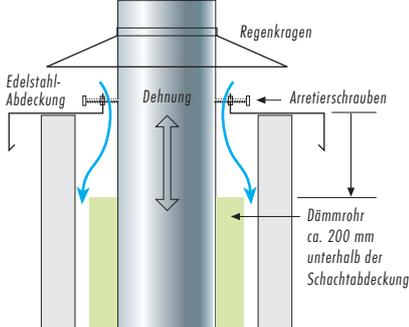
(Abb.13) Montage der Edelstahl-Abdeckung:
