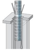
Nach dem Ablängen ist die Schnittkante des Flexrohres zu glätten und ein Ablassseil am Flexrohr zu befestigen. Anschließend wird das Flexrohr vom Schornsteinkopf aus in den Schacht eingeschoben. Dabei sollte an der unteren Öffnung das Führungsseil durch einen Helfer straff gehalten, bzw. leicht gezogen werden.
