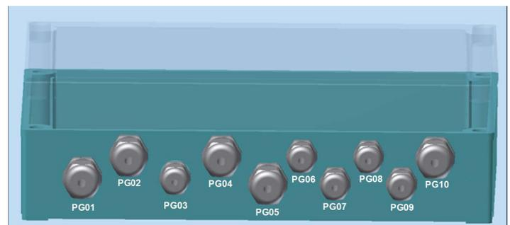
Abbildung 7: Anordnung der PG-Verschraubungen
