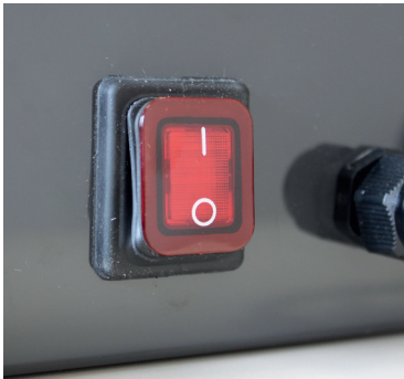
Abb. 18: Einschalten der Steuerung
