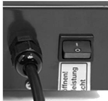
Abb. 22: Einschalten der Steuerung
