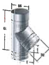
11) Feuerungsanschluss 45° mit Kondensatabtropfkante
