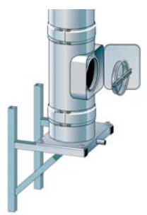
Stützkonstruktion für DW/FU an Außenfassade
